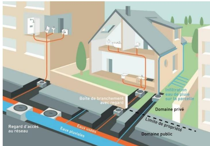
Cette collecte est réalisée via des canalisations et des postes de refoulement ou relèvement qui permettent de relever le niveau des canalisations lorsque l'écoulement gravitaire n'est plus satisfaisant :
