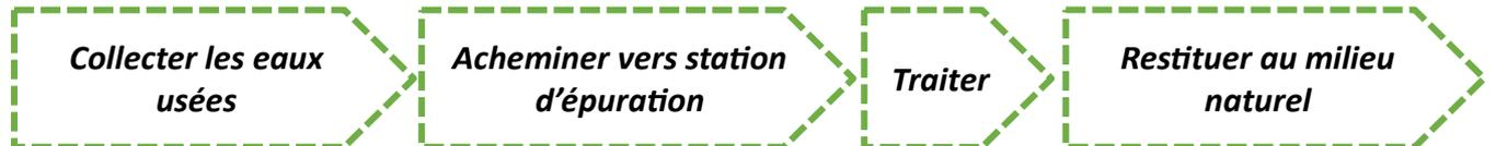
Les eaux usées sont ainsi collectées par des réseaux publics séparatifs ou unitaires et transitent par des postes de relevage pour être ensuite traitées par une station d'épuration.
